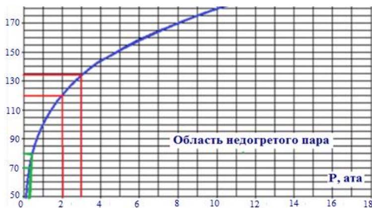
Рис.3. Классическая диаграмма линии насыщения системы “вода-пар”.
