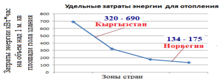
Рис. 1. Сравнительный график энергоэффективности отопления зданий в Норвегии и Кыргызстане.
