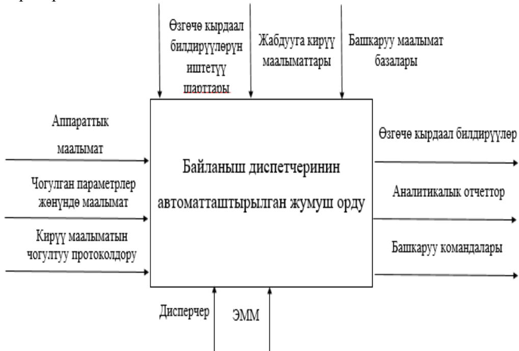
1-Сүрөт. АС функционалдык моделинин контексттик диаграммасы
