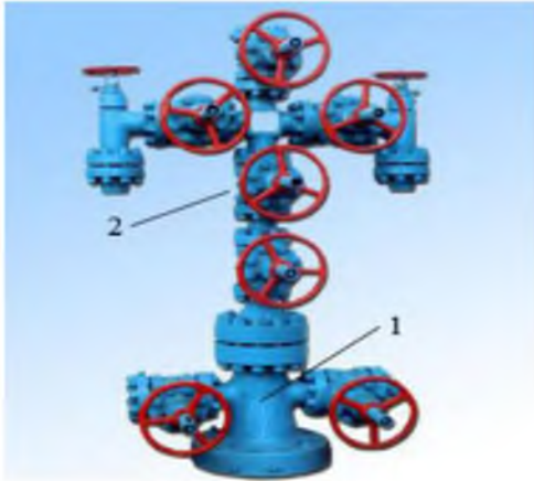
Рис. 7.4. Типовые схемы фонтанных елок: Схемы 1, 2, 3 и 4 – тройниковые; схемы 5 и 6 – крестовые (1 - переводник к трубной головке; 2 - тройник; 3 - запорное устройство; 4 - манометр с запорно-разрядным устройством; 5 - дроссель; 6 - ответный фланец; 7 - крестовина)
