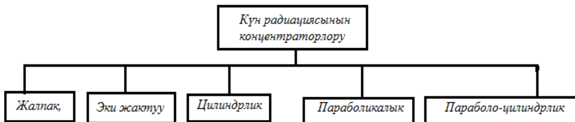
Сүрөт 2. Рефлектордун геометриялык формасы боюнча күн концентраторлорунун классификациясы
