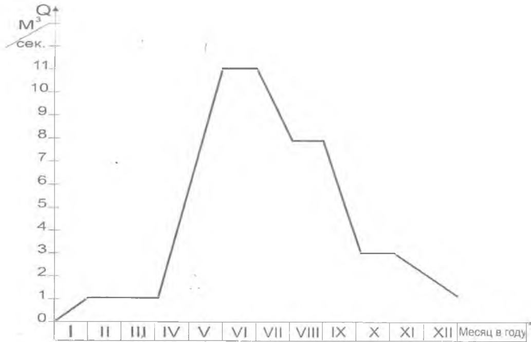
Рис.1 Типичный расход воды Q в горной реке в зависимости месяца в году Исходным данным для проектирования является уклон местности, и расход воды который течет сверху вниз. Для расчета золотосодержащей и чистой воды используем уравнение Бернулли: (рис 2)
